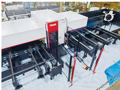
工場ではTeklaデータ対応の加工機を導入
